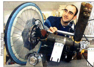
(gr.F.). Dirk Dietrich an der Antriebseinheit - das Fahrgestell stammt von einem Liegefahrad ab (F.o.).
