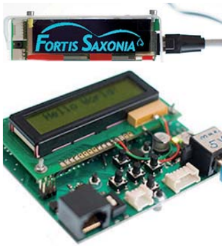
Abb. 08: Display (oben) und Platine mit aufgestecktem Display (unten).
