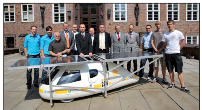
Abb. 15: Sax 1 nach dem Umbau. Die beiden Solarmodule erreichen zusammen einen maximal Leistung von 480 Watt.
