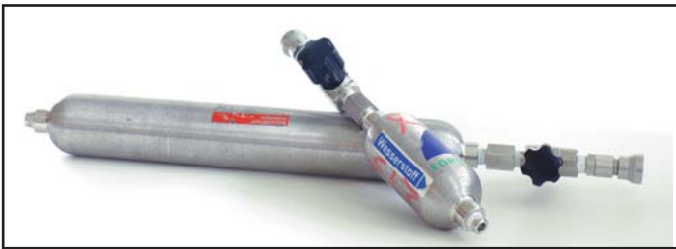
Abb. 16: Zwei vom HZG bereitgestellte Metallhydridspeicher mit einem Gesamtfassungsvermögen von zirka 180 Normliter Wasserstoff.
