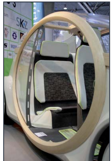
Abb. 12: Die Ellipsen dienen als Blickfang und zur Verteilung der Kräfte auf den Rahmen.
